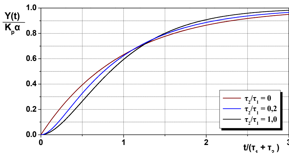
Εικόνα 6.15: Βηματική απόκριση διεργασίας δεύτερης τάξης ( \zeta \geq 1 ) για διάφορες τιμές του λόγου (\tau_2/\tau_1) .
