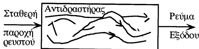
Σχήμα 14.1 Σχηματική αναπαράσταση των διαφορετικών διαδρομών που ακολουθούν οι στοιχειώδεις μάζες του ρευστού στο εσωτερικό αντιδραστήρα μη-ιδανικής ροής
